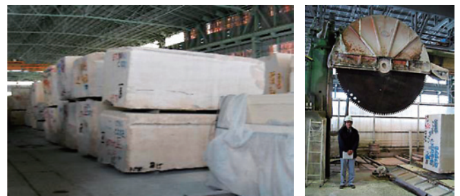
a) 輸入された大理石の原石 (1.5×1.5×3.0m程度) b) ダイヤモンドソー切断機
