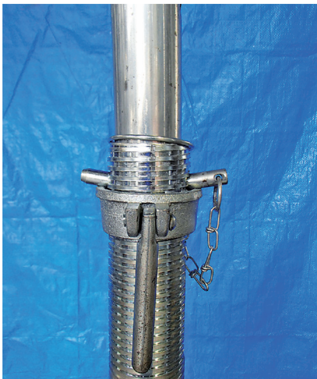
写真3 破壊状況 (試験体記号: CKK-40-N) 番号: 1 P_{max}=48.5 \text{ kN} ・支持ピンの曲げ変形
