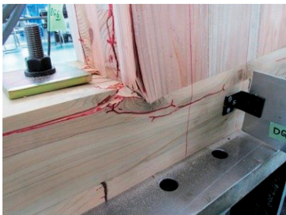
写真4 CLT壁柱の土台へのめり込み
