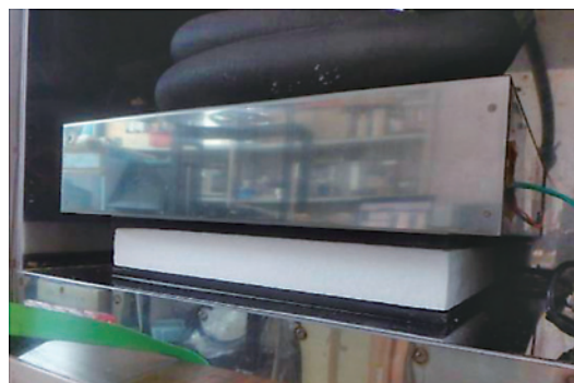
写真3 熱流計法の装置(試験体1枚・熱流計対象構成方式)
