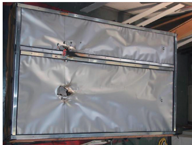
写真5 飛び火試験 試験終了後
