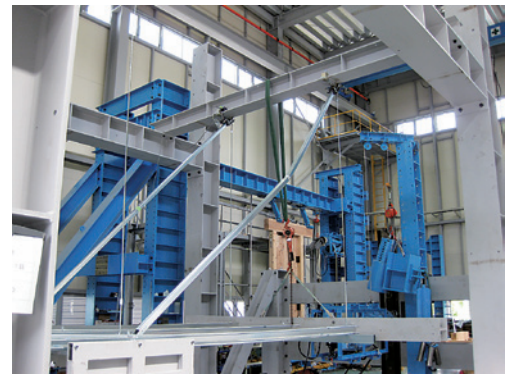
写真6 破壊状況 試験体記号：耐震スマート天井（1段）（SCS-020） 斜め補強材の座屈
