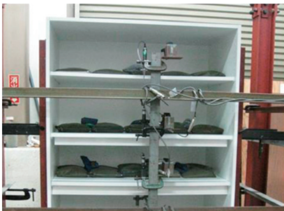
写真1 棚板のたわみ試験状況
