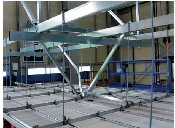
写真5 モデル5の終局状況 (斜め材の座屈)
