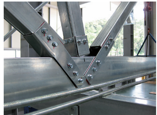
写真8 破壊状況 試験体記号：耐震スマート天井（1段）（SCS-021） 斜め補強材の座屈
