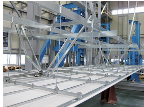
写真12 破壊状況 試験体記号：耐震スマート天井①+在来天井(SCS-063,064) 斜め補強材及び野縁受けの変形
