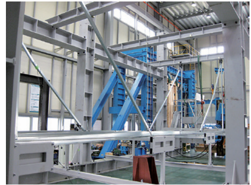
写真4 破壊状況 試験体記号：耐震スマート天井（1段）（SCS-019） 斜め補強材の座屈
