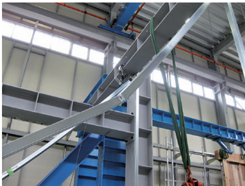
写真5 破壊状況 試験体記号：耐震スマート天井（1段）（SCS-019） 斜め補強材の座屈
