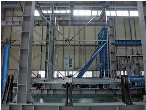
写真11 破壊状況 試験体記号：耐震スマート天井(2段)(SCS-059,060) 斜め補強材の座屈
