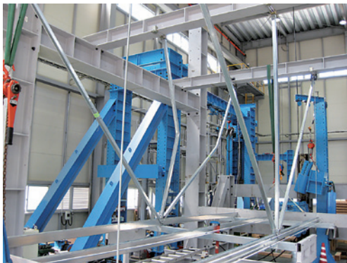
写真7 破壊状況 試験体記号：耐震スマート天井（1段）（SCS-021） 斜め補強材の座屈
