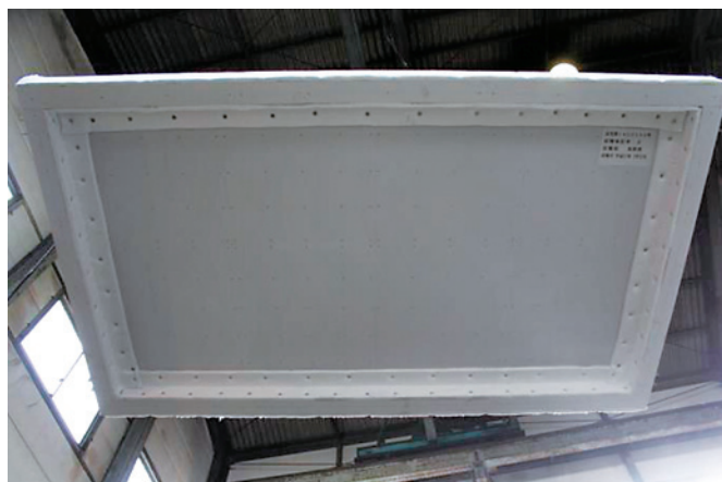
写真8 試験前の加熱側の状況 (けい酸カルシウム板仕様)
