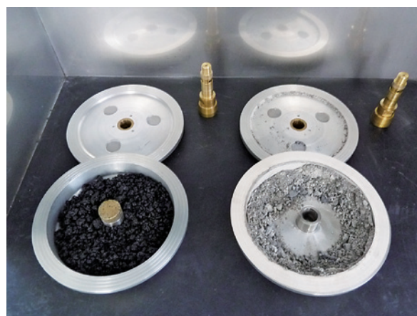
写真3 アスファルト抽出試験 (左側：抽出前, 右側：抽出後)
