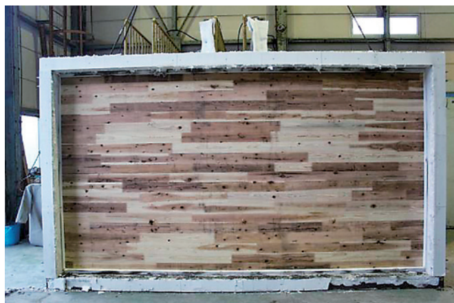
写真13 試験後の加熱側の状況(けい酸カルシウム板仕様) (CLT表面の状況)
