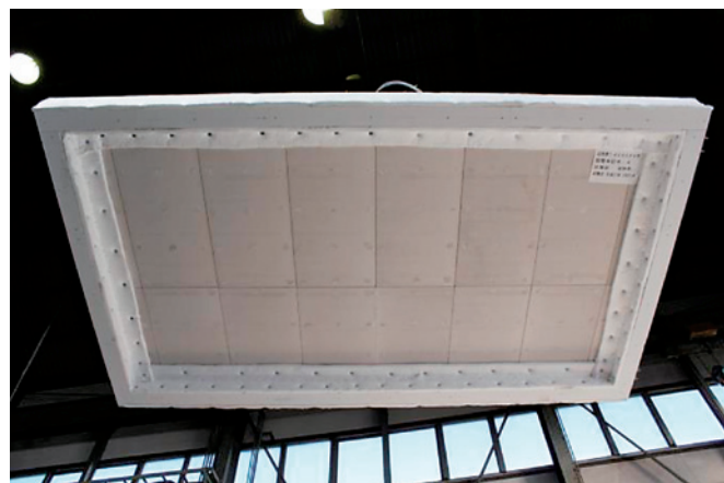
写真3 試験前の加熱側の状況(ALC板仕様) (ALC表面の状況)
