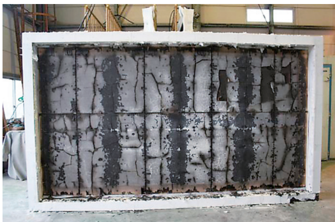
写真10 試験後の加熱側の状況(けい酸カルシウム板仕様) (上張強化せっこうボードの状況)
