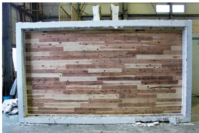
写真7 試験後の加熱側の状況(ALC板仕様) (CLT表面の状況)
