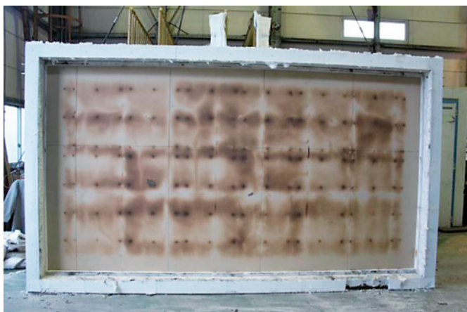
写真6 試験後の加熱側の状況(ALC板仕様) (下張強化せっこうボードの状況)
