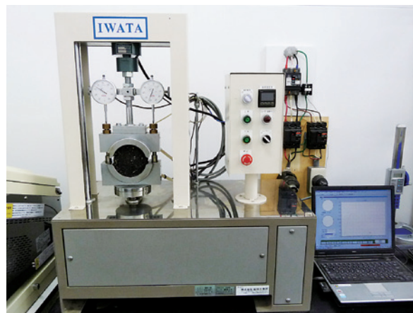
写真5 マーシャル安定度試験状況
