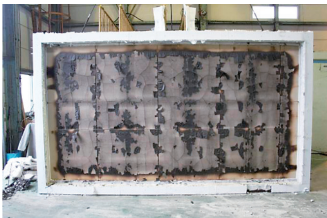
写真5 試験後の加熱側の状況(ALC板仕様) (上張強化せっこうボードの状況)
