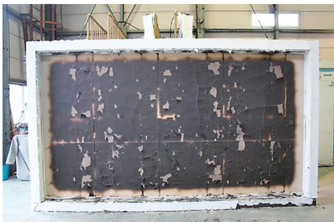
写真11 試験後の加熱側の状況(けい酸カルシウム板仕様) (中張強化せっこうボードの状況)
