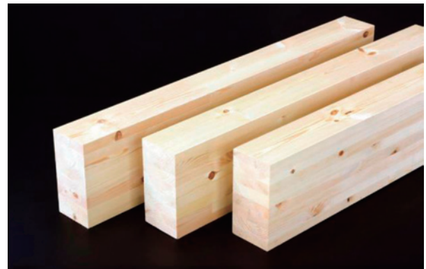
写真1 集成材の外観 [3]
