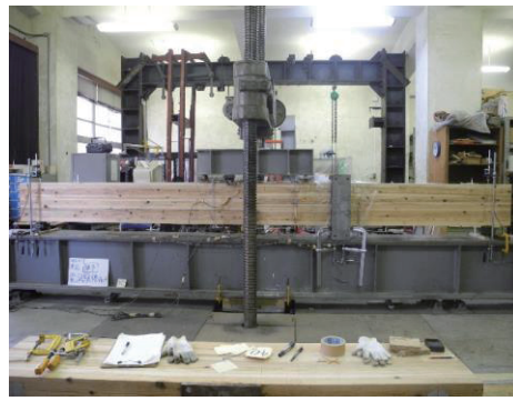
写真4 梁（縮尺2/3）の曲げ試験
