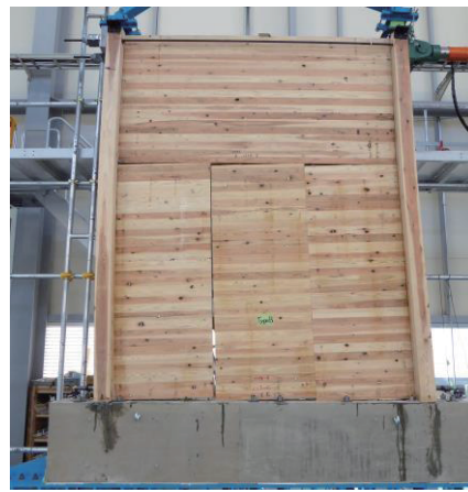
写真5 CLT耐震壁（3分割、破壊後）
