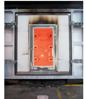
写真2 壁載荷加熱炉の試験
