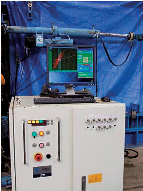
写真1 コンピューターによる自動制御式加力試験機
