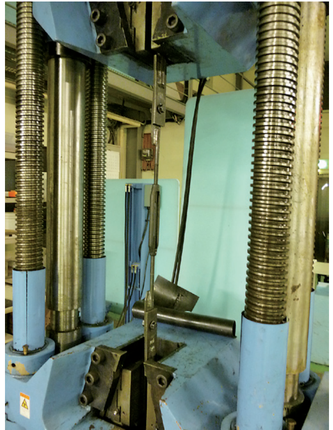
写真1 ターンバックルの引張試験
