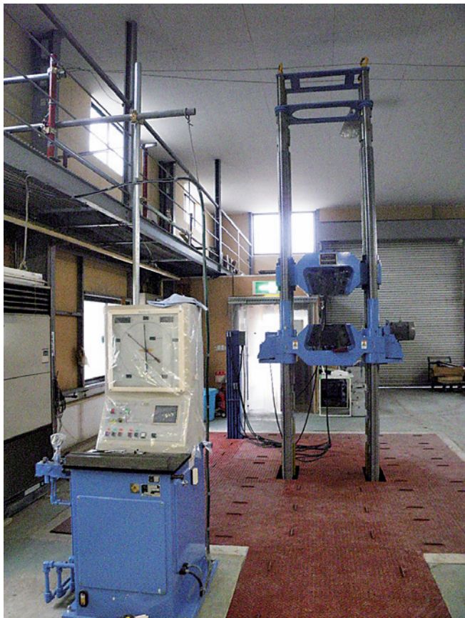
写真2 2000kN多用途型万能試験機
