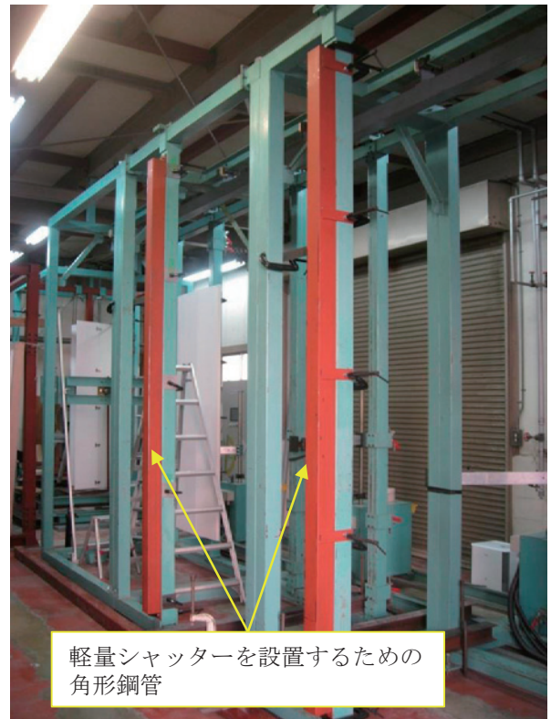
解説写真1 試験体設置用の角形鋼管
