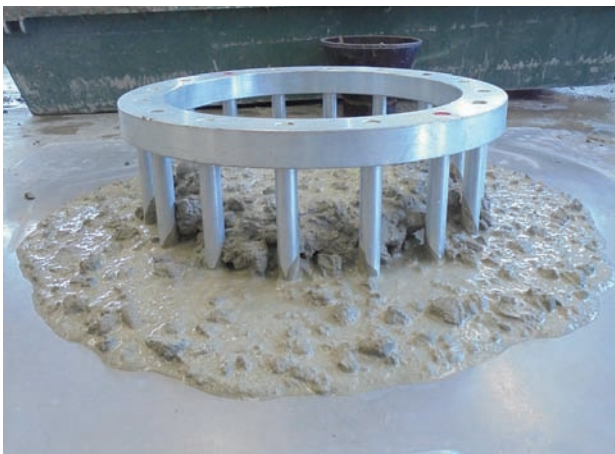
写真7 Jリングの障害で骨材がアーチングしている状況
