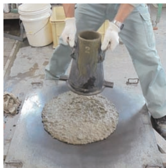
写真2 スラップフロー試験の状況
