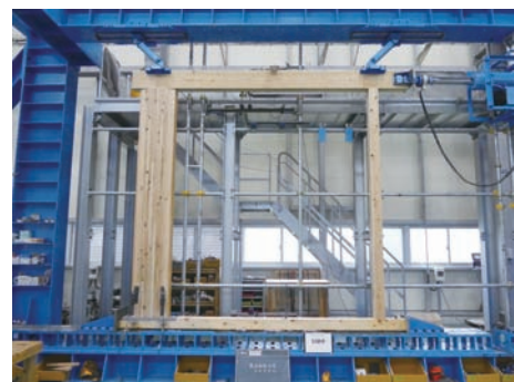
写真1 試験実施状況（大型面内せん断試験装置）
