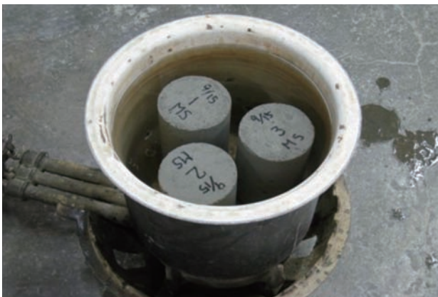
写真1 コンクリートによるポップアウトの確認試験状況(煮沸法)の一例
