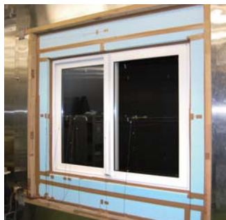
写真1 試験体設置状況
