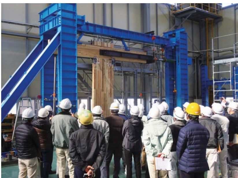
CLT耐力壁の面内せん断公開試験の様子
