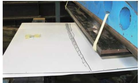
写真2 破壊状況(試験体記号: GX-1-1)
