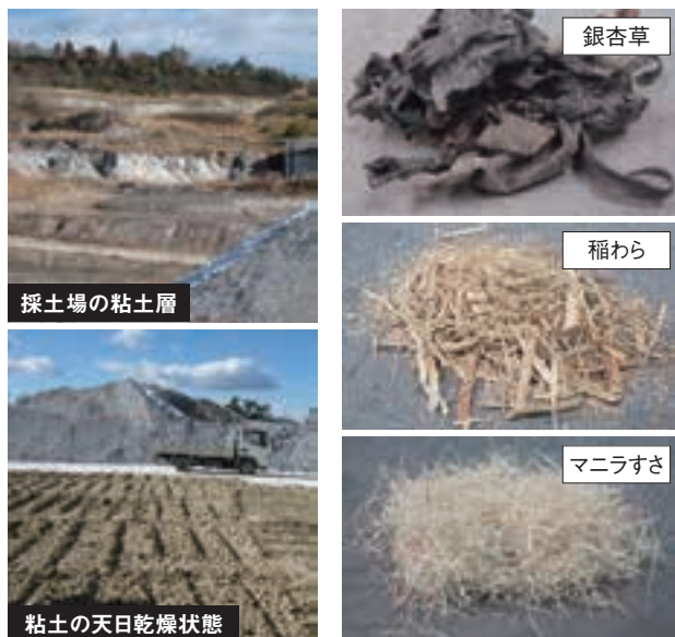
写真1 壁土の採取状況と主な使用材料
