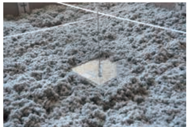
写真3 密度試験状況(厚さ測定)
