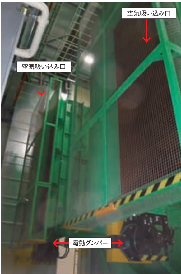
写真9 大型送風散水試験装置(上流側)
