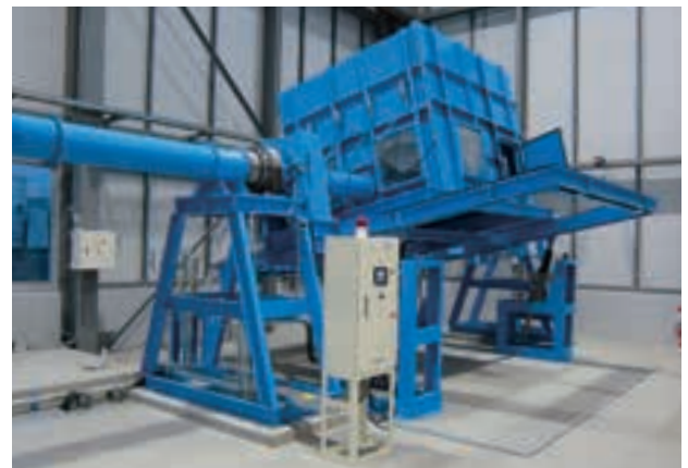
写真6 屋根チャンバー(試験体2050mm×2100mm時)
