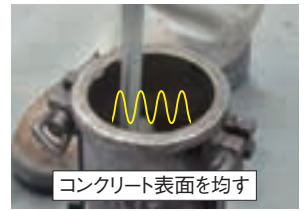
写真16 表面の均し・突き深さ
