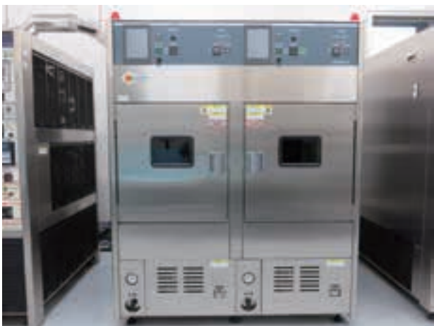
写真1 2槽独立型スーパーキセノンウェザーメーターの外観
