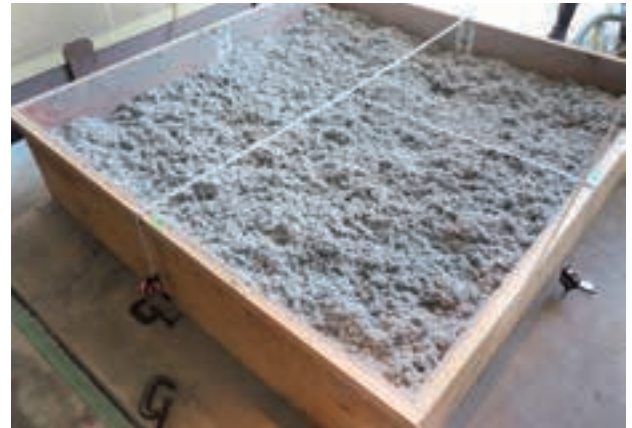
写真1 密度試験状況(天井製品)
