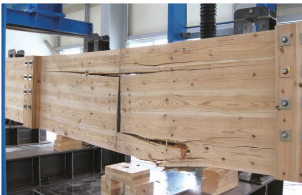
写真2 破壊状況(番号:1)
