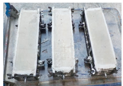
写真3 コンクリート打設後の状況
