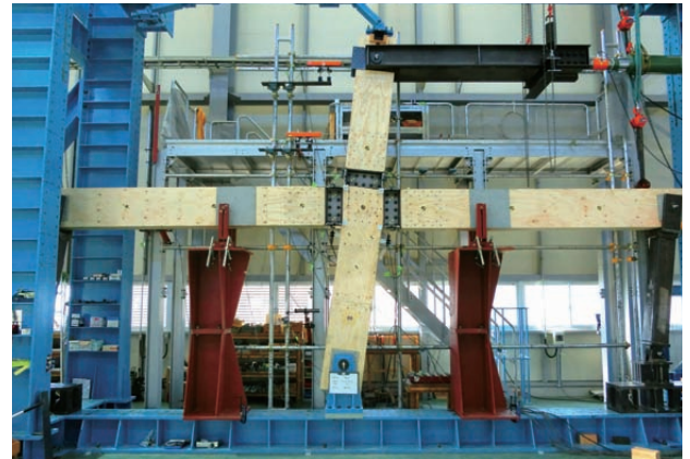
写真5 試験体の終局状況(全景)
