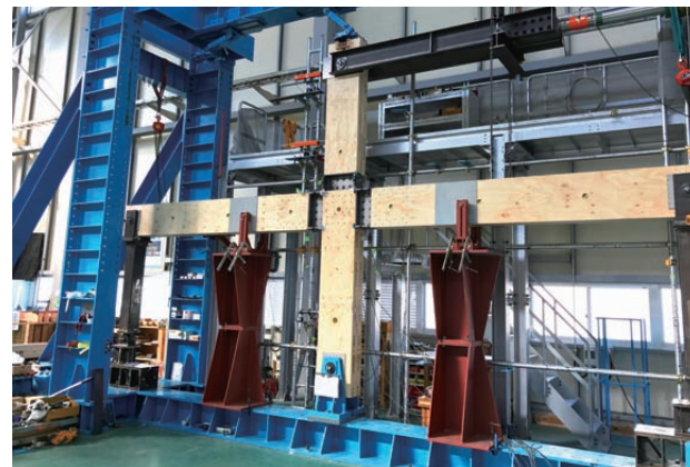
写真4 十字形要素試験体の設置状況
