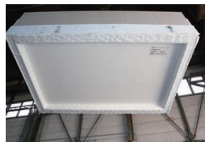
写真3 試験前の加熱側の状況
