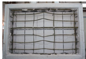
写真5 試験後の加熱側の状況
