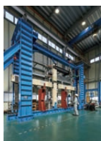
[今号の表紙] 高靱性木質ラーメン構造の 十字形水平加力試験
