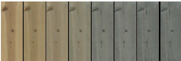
写真4 外部に置いた木材の色の変化
