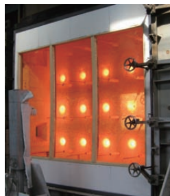
写真2 遮炎性能試験の状況
