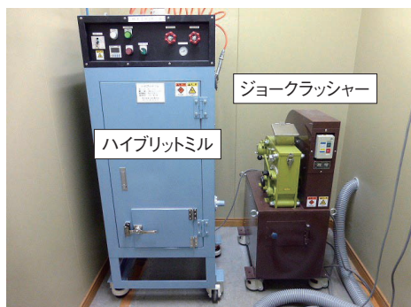
写真2 コンクリートの粉砕装置
