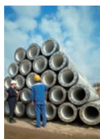
[今号の表紙] JIS認証審査における 製品の外観検査の様子
