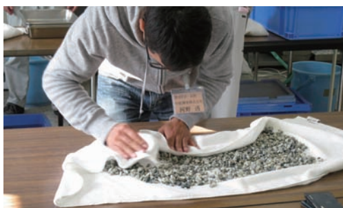
密度及び吸水率試験の実習
