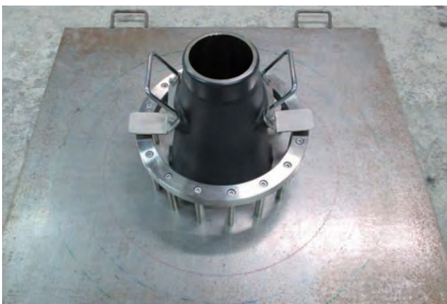
写真3 ステップが取り付けられたスランプコーンの例 (左:スランプコーンの中程にステップを設置した装置、右:スランプコーンの取手にステップの取付けができる装置)
