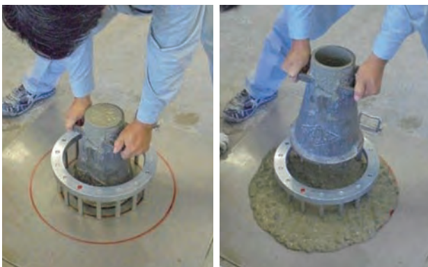
写真4 Jリングフロー試験の状況
