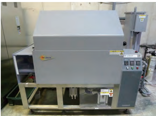
写真1 塩水噴霧試験装置の外観
