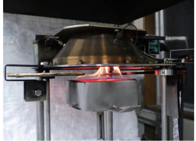
写真2 セッコウボードの燃焼時の状況
