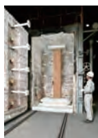
[今号の表紙] 木製柱の耐火試験体
