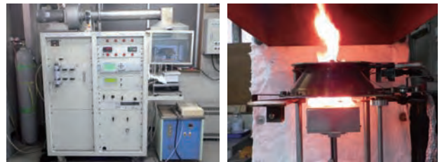
写真1 発熱性試験装置外観および試験実施状況
