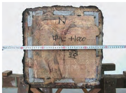
写真2 柱の燃え止まりの事例 (提供:竹中工務店 耐火集成材「燃エンウッド®」)
