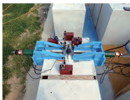
写真6 アンカーサイズD35の繰返しせん断試験状況
