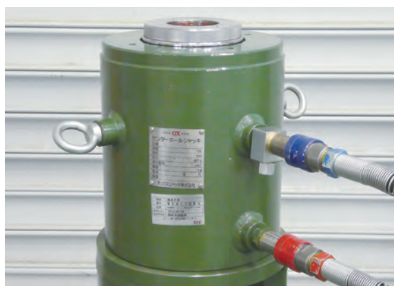
写真2 複動型センターホールジャッキの外観
