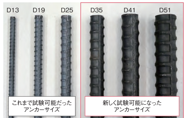
写真1 試験可能なアンカーサイズの例
