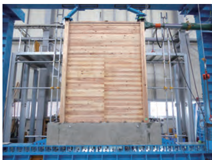
写真2 RC基礎付き鉄筋入り集成材工法の面内せん断試験状況
