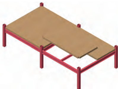
図5 鋼構造のフレーム+CLT床の概念
