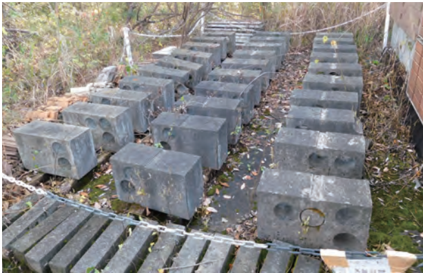
写真1 供試体養生状況
