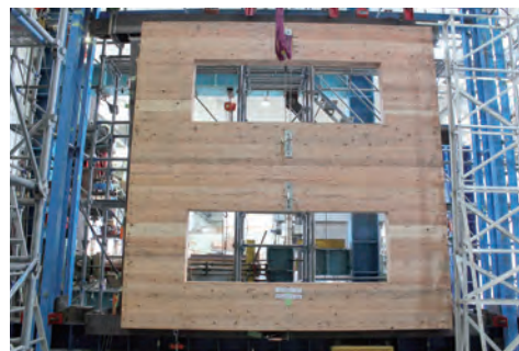
写真3 鉄骨フレーム+CLT床の実大せん断試験 (大分大学で実施)
