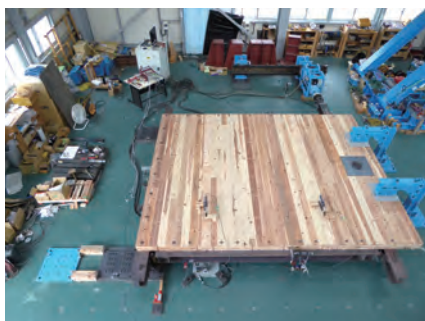
写真3 CLT材を用いた床の面内せん断試験状況
