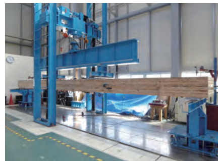
写真5 CLT材を用いた重ね梁の曲げ試験状況
