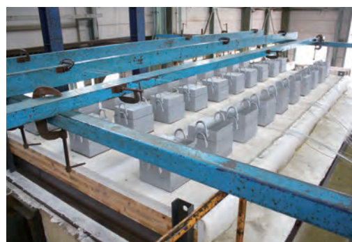
写真1 CLT材を用いた床の2時間耐火試験状況
