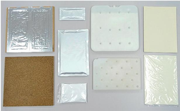
写真1 潜熱蓄熱建材の製品例
