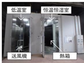
写真2 熱貫流率試験装置
