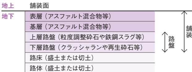
図1 舗装道路の構成例
