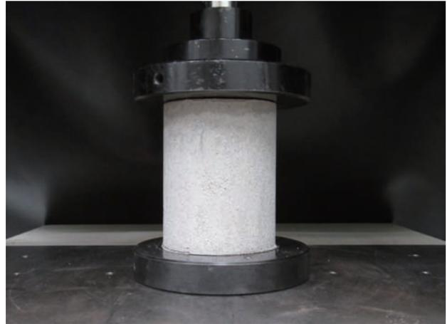
写真4 一軸圧縮試験状況
