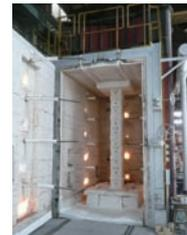
写真1 柱の耐火性能試験の状況例
