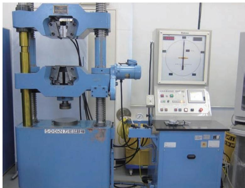
写真1 500kN万能試験機の外観
