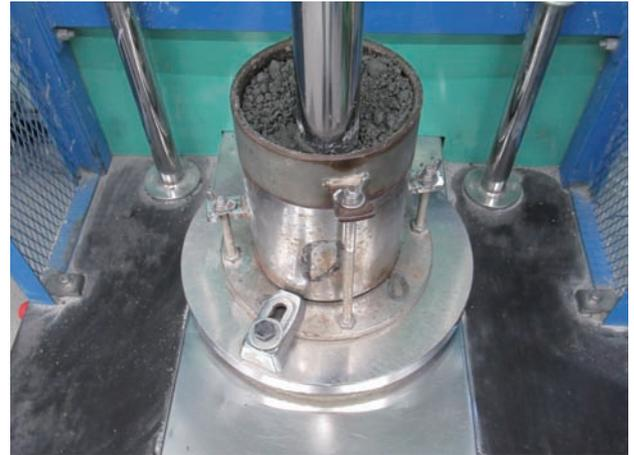
写真2 突固め状況
