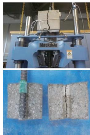
写真1 JSTM C 2101の試験状況(D41の場合)
