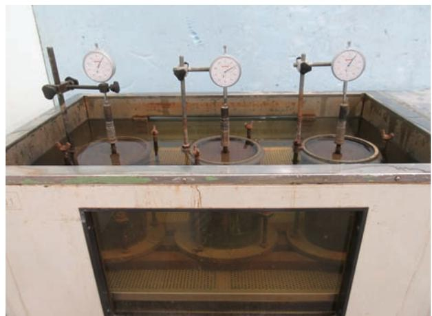
写真5 水浸膨張試験状況
