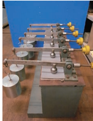
写真2 ヘこみ試験状況
