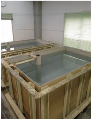
写真1 水密試験状況
