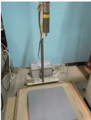
写真3 耐衝撃試験状況
