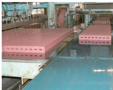
b) 押し出し成形とピアノ線切断
