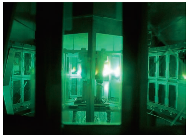
写真5 耐候性試験の照射状況
