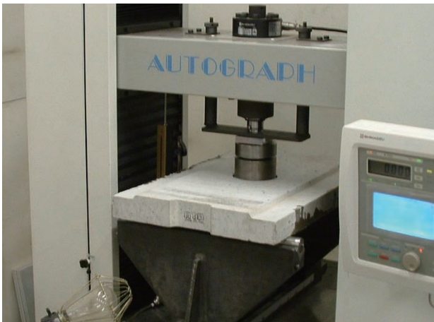
写真2 押抜き試験の一例
