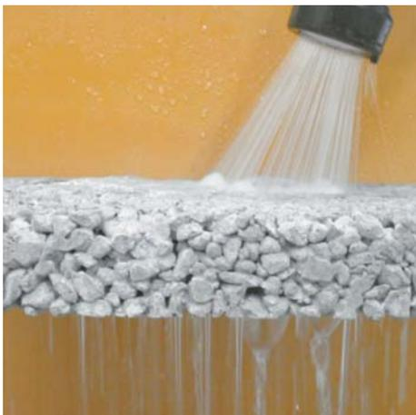
写真1 連続する空隙を有するポラスコンクリート
