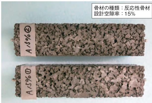
写真4 設計空隙率15%の試験体
