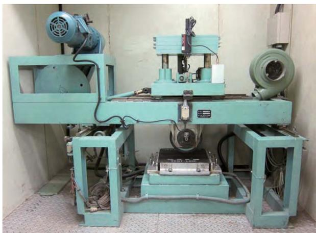
写真2 ホイールトラッキング試験装置
