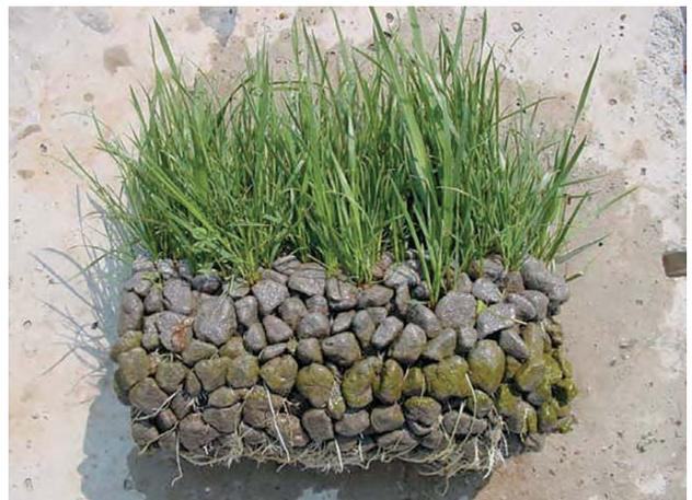
写真2 ポラスコンクリートの適用事例
