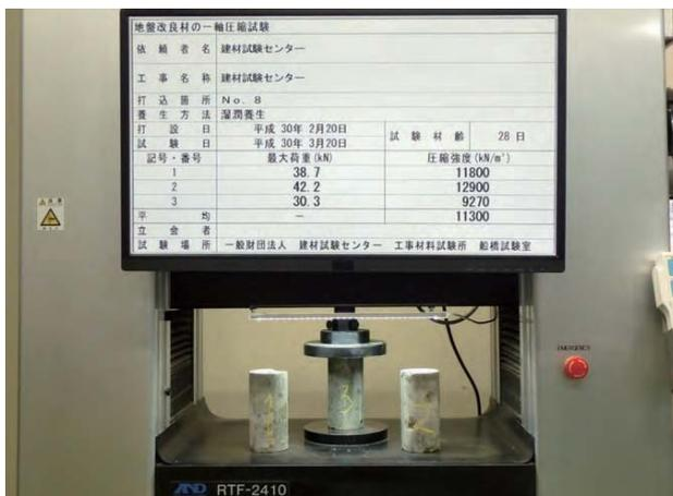
写真6 100kN一軸圧縮試験機と電子黒板
