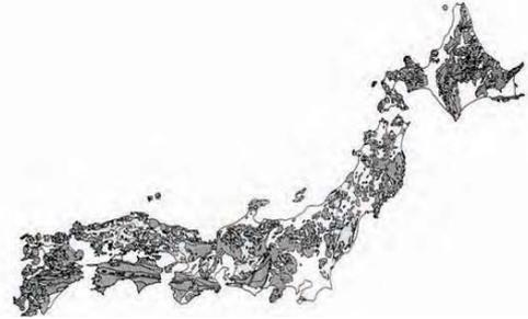
図1 アルカリシリカ反応性骨材分布図<sup>3)</sup>
