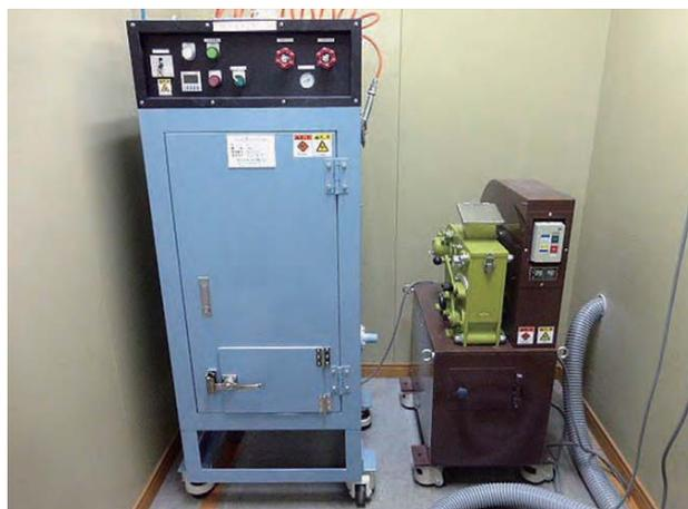
写真4 コンクリートの粉砕装置
