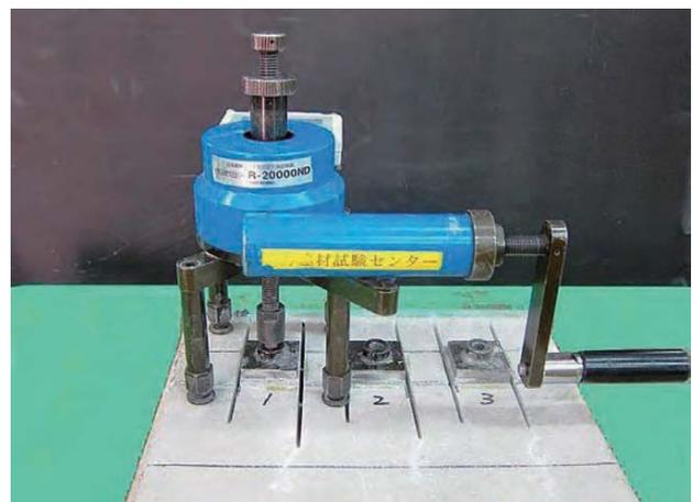
写真12 モルタルの接着強さ試験状況
