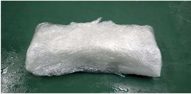
写真3 試験体の封かん養生の様子
