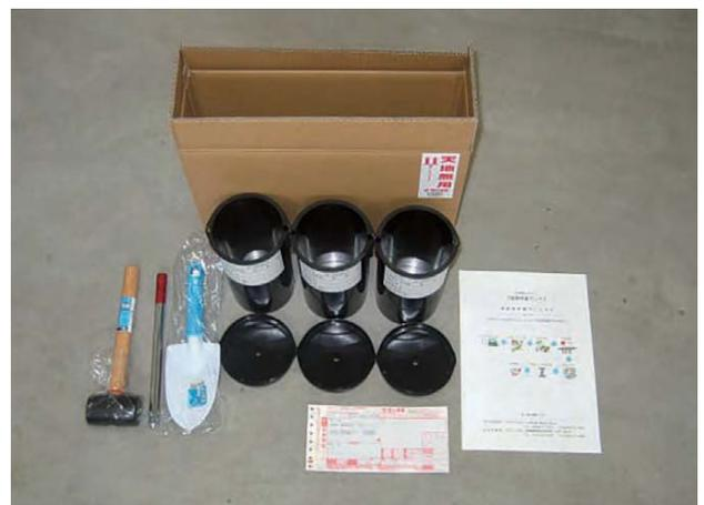
写真8 圧縮強度検査セット
