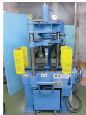
写真2 300kN曲げ試験機 (浦和試験室)
