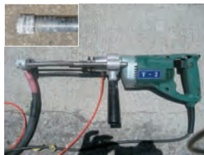
写真4 湿式二軸低騒音ドリル [ \phi 6.5mm]
