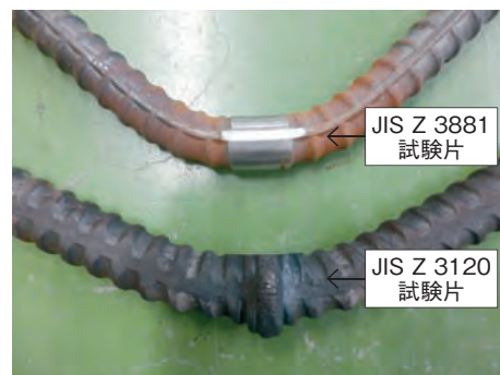
写真5 ガス圧接継手の曲げ試験片（試験後）
