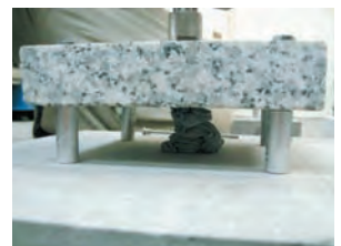
写真10 樹脂の注入状況
