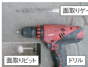
写真5 面取り作業用工具 [面取りビット、ドリル及び 面取りゲージ]
