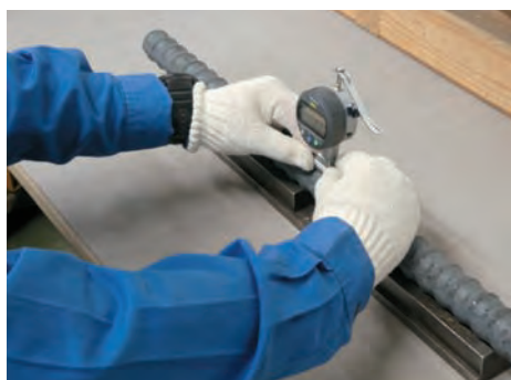
写真3 鉄筋の形状、寸法試験状況（節の高さ）
