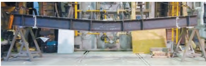
写真2 単純支持梁試験体の変形状況
