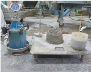
写真1 フレッシュコンクリートの試験状況
