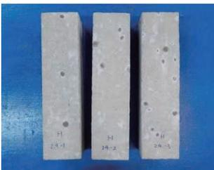
写真5 供試体の脱型後の状況
