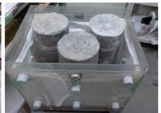
写真14 円柱供試体の湿気箱内での設置状況
