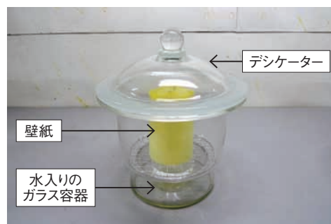
写真1 ホルムアルデヒドの放散量試験状況
