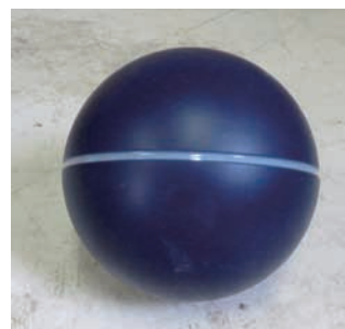
写真2 標準重量衝撃源[衝撃力特性(2)]
