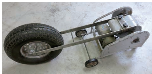
写真1 標準重量衝撃源[衝撃力特性(1)]
