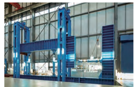
写真1 大型複合加力試験装置
