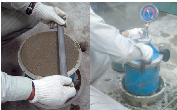
写真2 空気量試験状況
