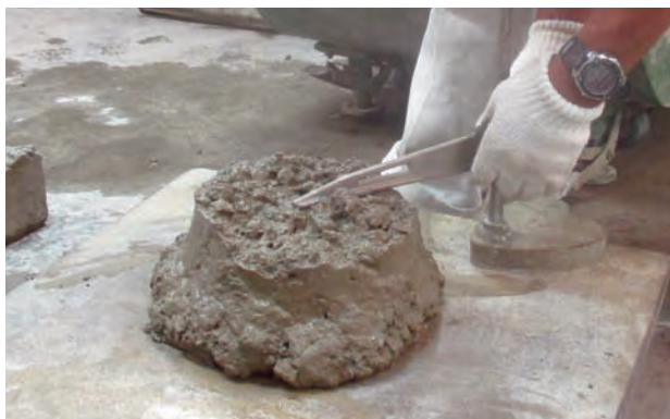
写真1 スラップ試験状況
