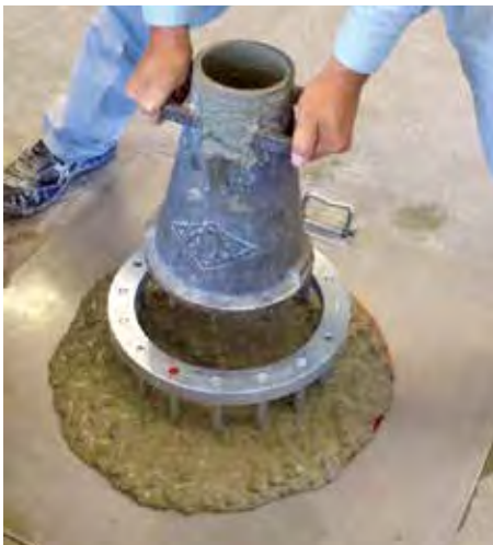
写真5 Jリングフロー試験の状況 9)
