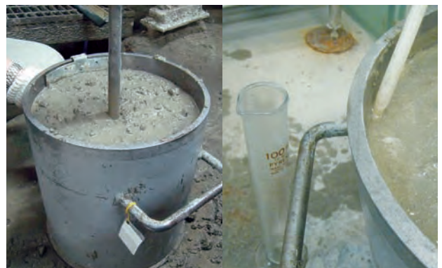
写真3 ブリーディング試験状況
