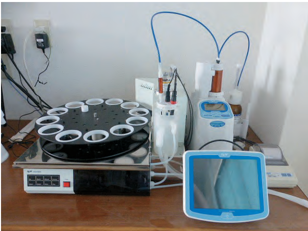
写真5 電位差自動滴定装置
