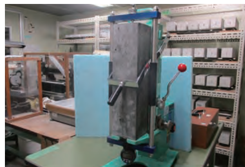
写真6 長さ変化測定状況
