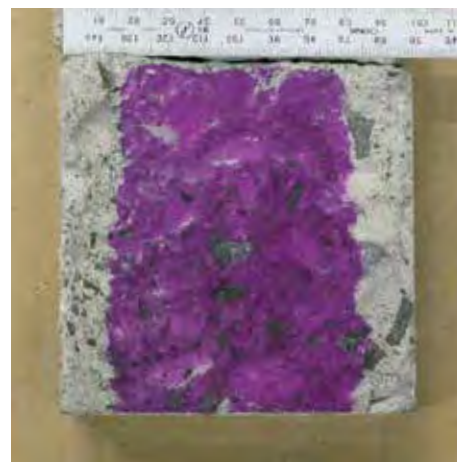
写真4 促進中性化試験結果の一例
