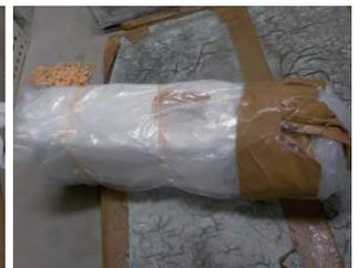
写真8 供試体の被覆状況(ポリ袋)
