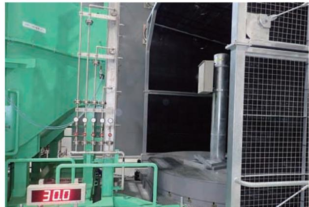
写真4 キャビネットの送風散水試験
