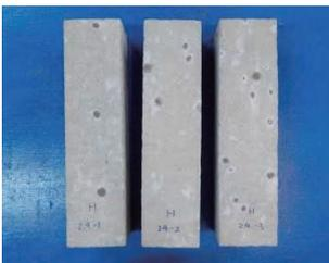
写真5 供試体の脱型後の状況
