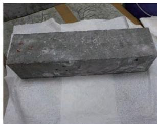
写真6 供試体の被覆状況(吸水紙)
