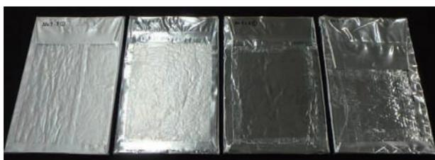
写真1 真空断熱材の例
