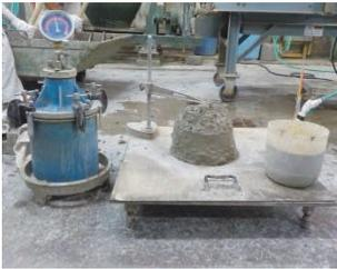
写真1 フレッシュコンクリートの試験状況
