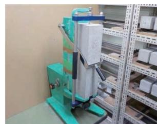
写真9 長さ変化測定状況(ダイヤルゲージ方法)
