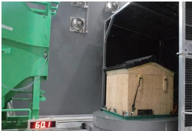
写真3 瓦葺き屋根の送風試験
