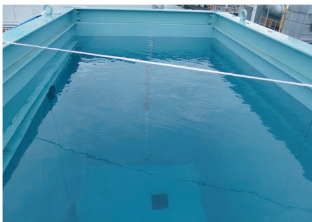
写真3 浸水防止性能試験及び耐水圧性能試験実施状況 （設定水位まで水を注水した状態）
