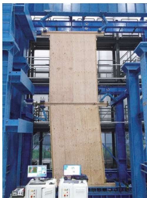
写真3 破壊状況 全景
