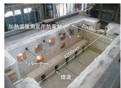
写真1 水平試験炉①
