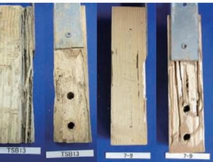
写真4 腐朽(上)とシロアリ(下)の食害例
