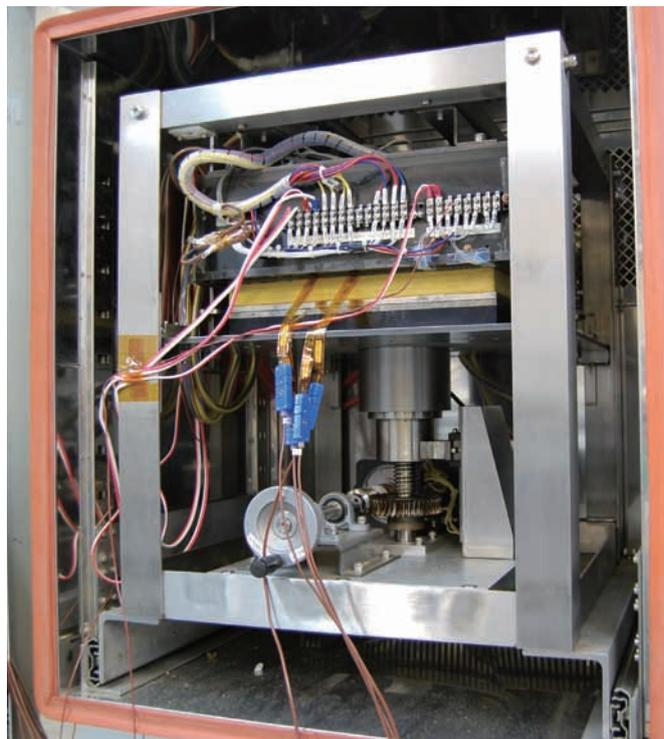
写真1 熱伝導率校正装置
