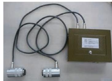
写真3 超音波伝播速度計測器
