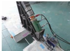
写真5 斜め45度荷重試験
