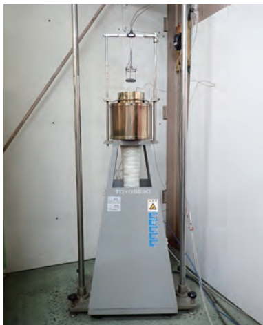
写真1 不燃性試験装置
