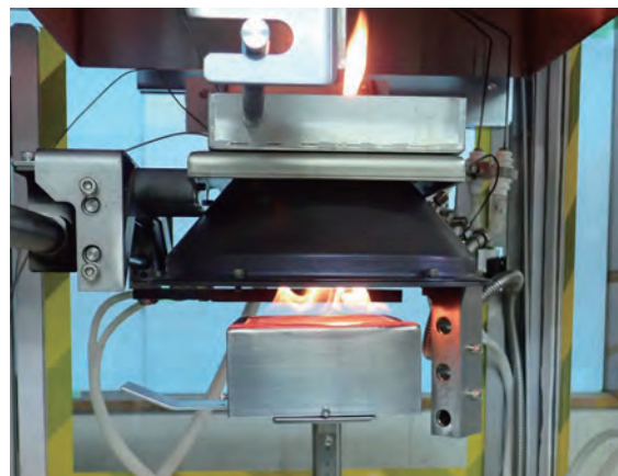
写真2 試験時の試験体からの発炎
