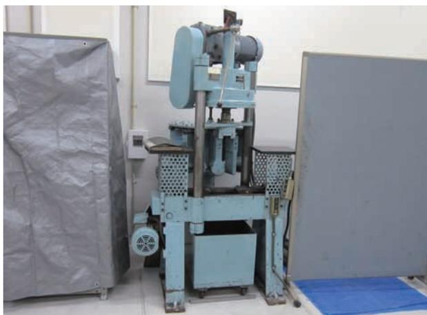
写真8 鋼材曲げ試験機
