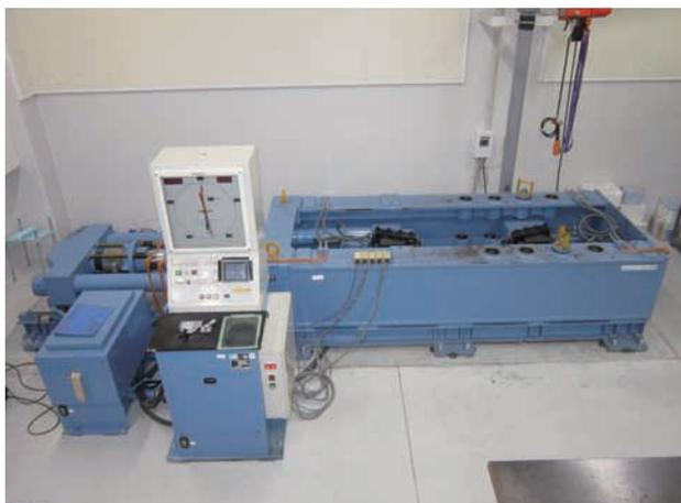
写真7 2000kN引張試験機
