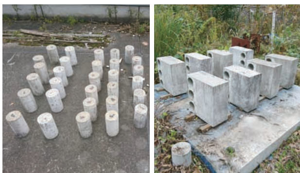
【円柱供試体】 【壁模擬部材(コア)】 写真1 屋外暴露の様子
