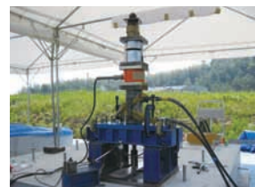
写真4 鉛直荷重試験
