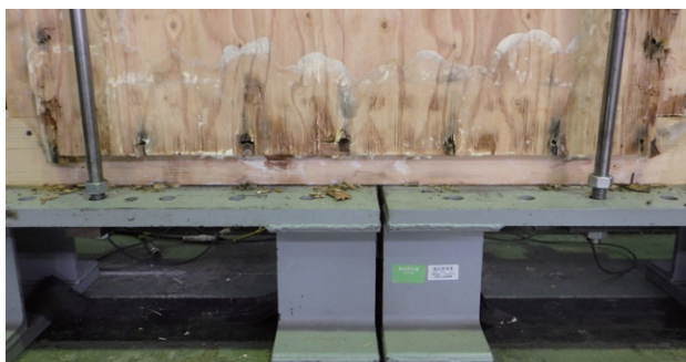
写真7 腐朽を受けた合板耐力壁の試験時の様子
