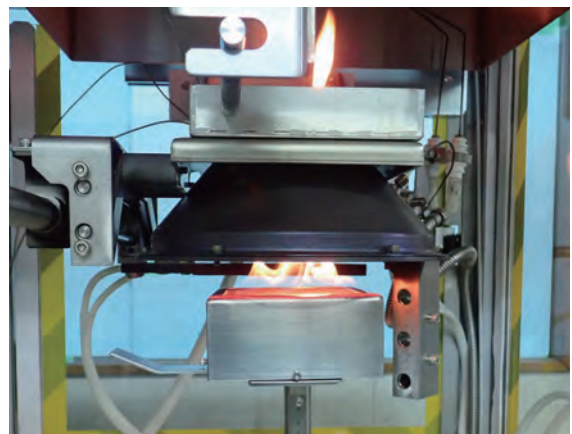
写真2 試験時の試験体からの発炎
