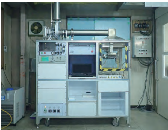
写真1 発熱性試験装置(コーンカロリーメーター)
