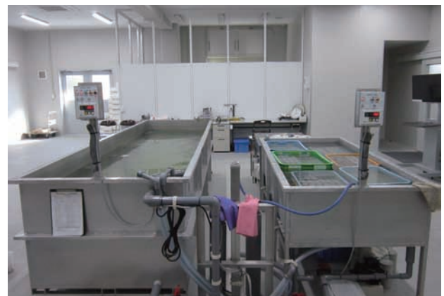
写真6 標準養生水槽
