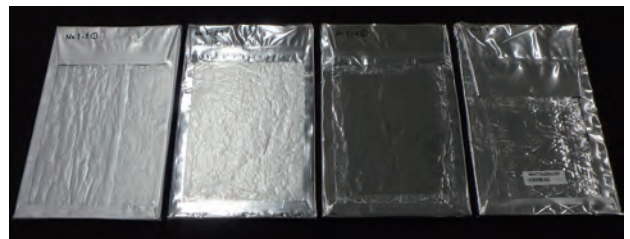
写真1 真空断熱材の外観(例)
