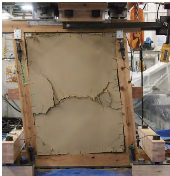
写真1 水平加力実験の状況
