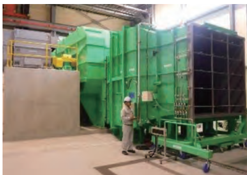
写真5 大型送風散水試験装置
