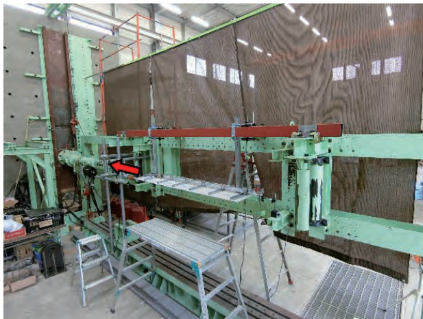
写真2 長手方向加力風景（ふところ600mm試験体）
