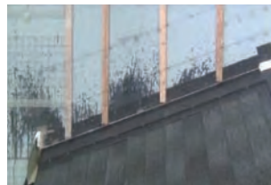
写真6 雨水浸入結果 (通気層上部構造：B) 実験時間 5分
