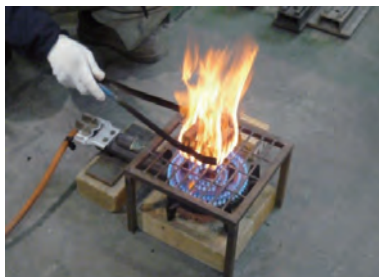
写真2 ガスバーナーによる火種の着火
