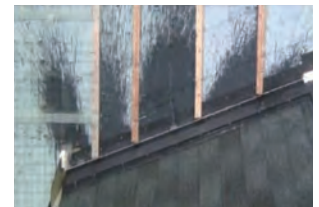
写真7 雨水浸入結果 (通気層上部構造：B) 実験時間 30秒
