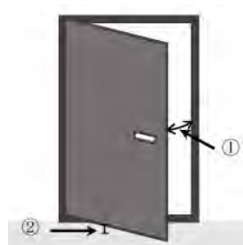
図2 ドア（扉）の隙間・開口部の例
