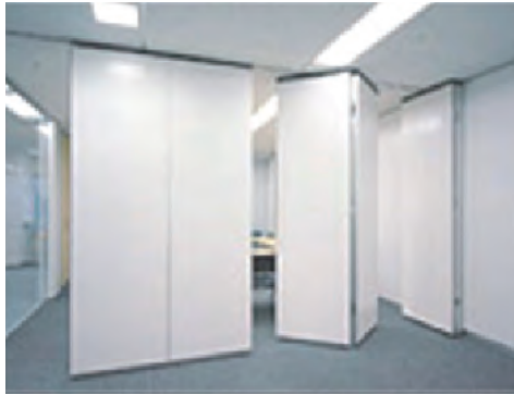
図15-8 ヘアパネル式 2枚単位でスライディング格納
