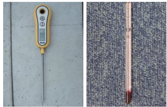
写真1 デジタル温度計とアルコール温度計
