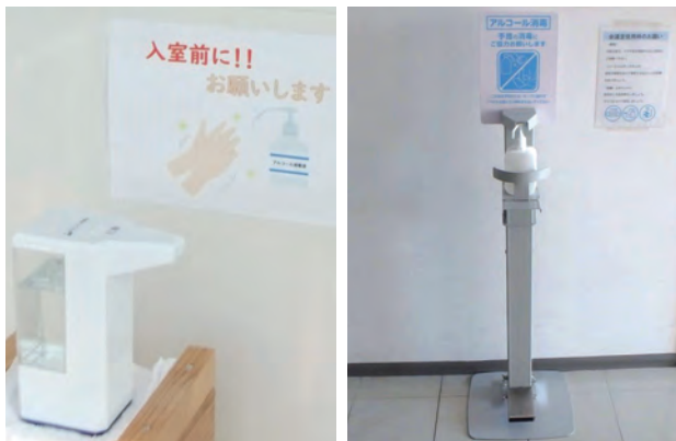
写真2 (左) 手をかざすとアルコールが噴霧される機器、(右) 足で踏むとアルコールが噴霧される
