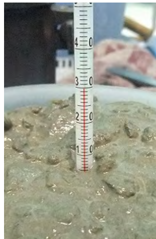
写真4 温度計の挿入状況 （検温部全体を試料に挿入）
