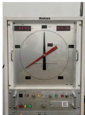
写真11 検力器部分(武蔵府中試験室)
