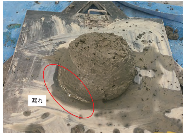
写真5 漏れおよび平板の汚れ i)
