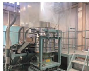
路盤材のふるい分け試験装置
