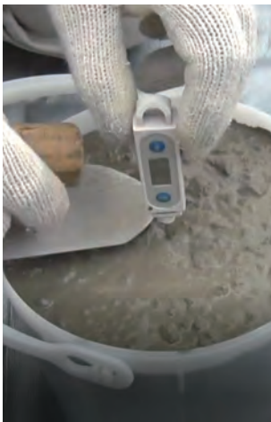
写真3 温度計の挿入状況 （中央部に垂直）
