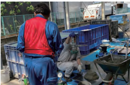
写真4 コンクリートのスランプ試験
