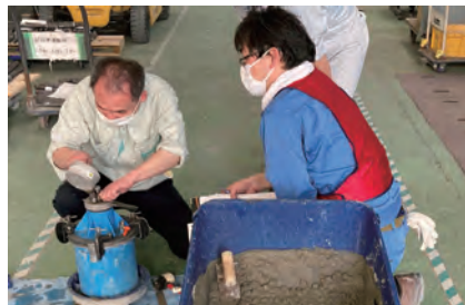
写真6 コンクリートの空気量試験
