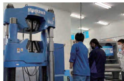
写真7 岡本職員指導による鉄筋の引張試験実習
