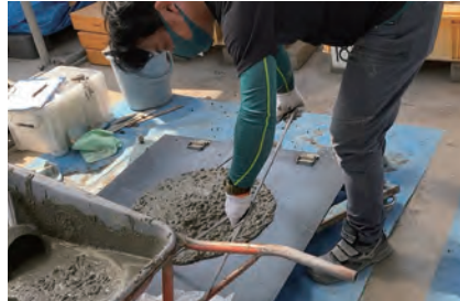
写真5 コンクリートのスランプフロー試験
