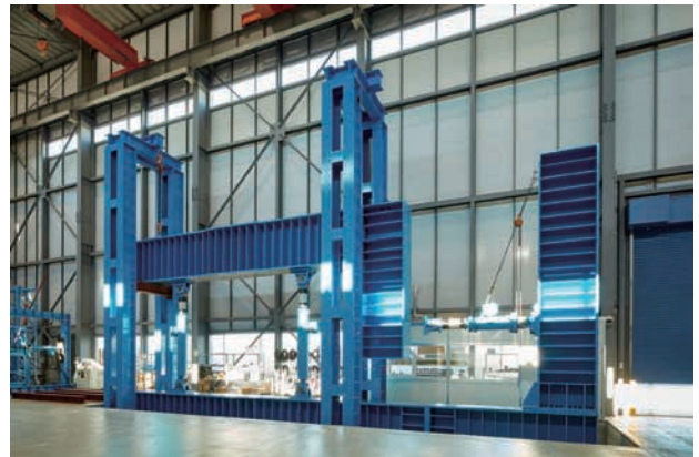
写真2 大型構造物複合加力試験装置の外観【構造試験棟】
