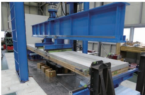
曲げ実験:クリープ実験未実施の試験体 (2018年1月実施)
