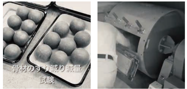
写真4 すりへり試験 (JIS A 1121) の動画
