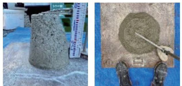
写真3 本日のスランプ (左: 固め、右: 柔らかめ)
