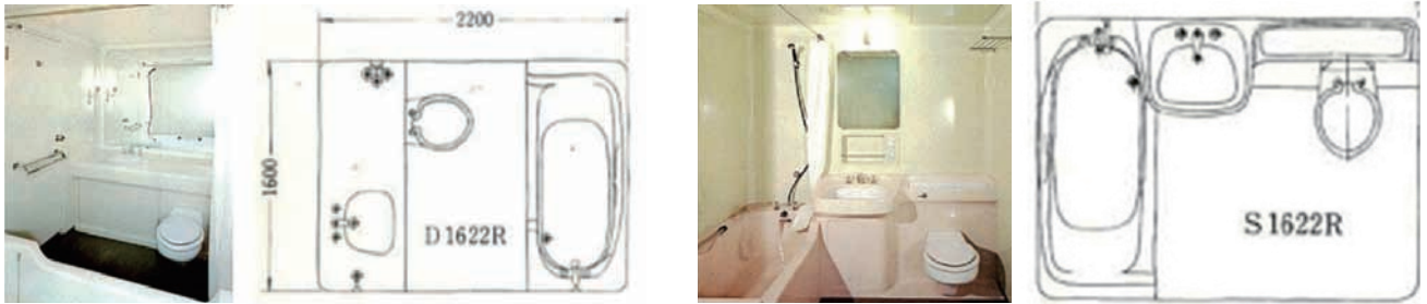
図16-10 1960年代の浴室ユニットの内部構成 1970 (S45) 年頃迄はオーダーメイドで、形状・寸法は多様。
