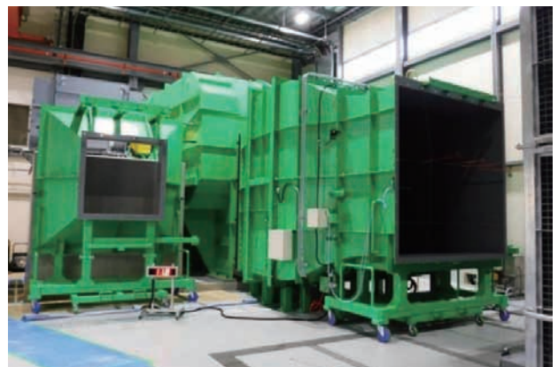
写真4 大型送風散水試験装置の外観【動風圧試験棟】 [右:吹き出し口2500mm×2500mm試験用] [左:吹き出し口1400mm×1400mm試験用]
