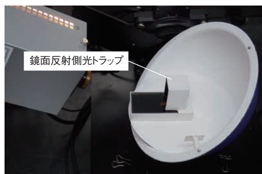
写真3 積分球内部での光源照射状況 (再帰反射側四分球反射率、入射角度60°、内部状況を見やすくするため、上部を解放した状態で撮影)
