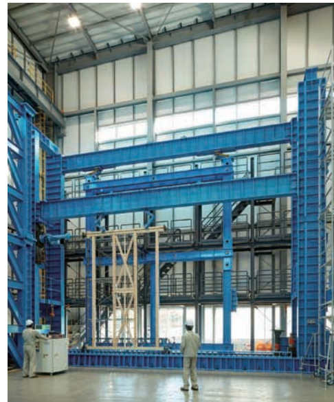
写真3 多層構面用水平加力試験装置の外観【構造試験棟】
