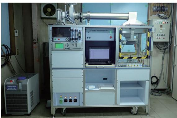
写真1 発熱性試験装置
