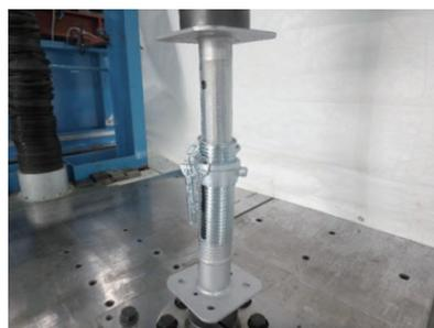
写真1 試験体：1尺 ナイフエッジ押し
