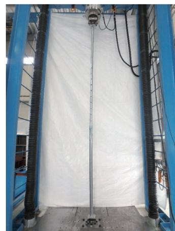
写真3 試験体：9尺 ナイフエッジ押し
