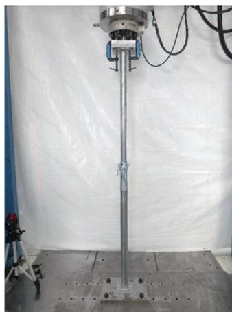
写真2 試験体：4尺 平押し
