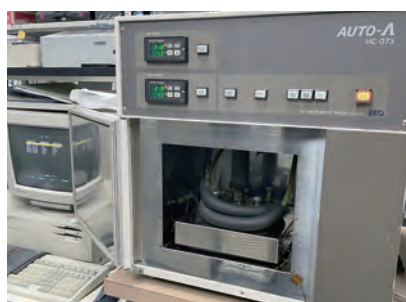
写真1 試験装置外観(熱板寸法 200mm)
