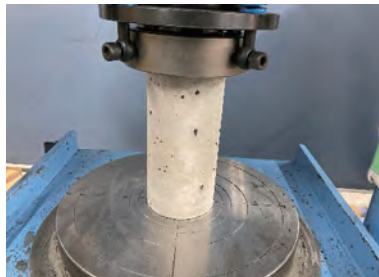
写真4 コンクリートの圧縮強度試験
