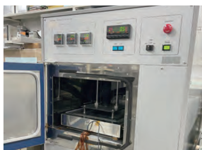
写真2 試験装置外観(熱板寸法 300mm)
