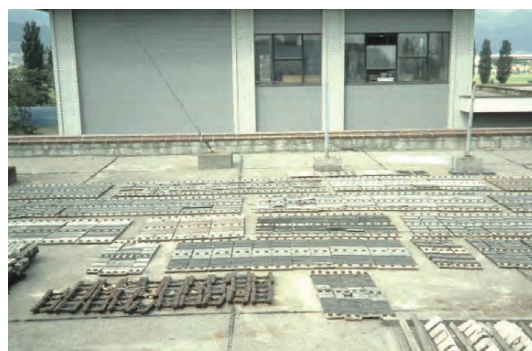
写真1 試験体の屋外暴露試験（前方建物にじゃまされているが、後方に北大ポプラ並木の一部が写っている。）
