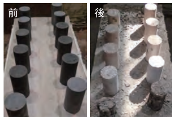
写真9 円筒供試体加熱試験・実施前後
