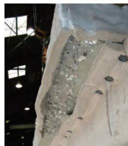
写真4 梁試験体の床部分での爆裂
