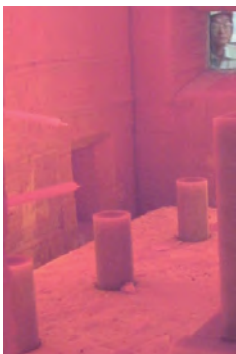
写真8 円筒供試体加熱試験・実施中の状況
