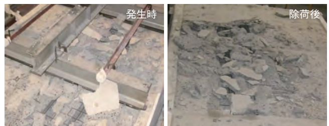
写真6 床試験体の爆裂(甚大)
