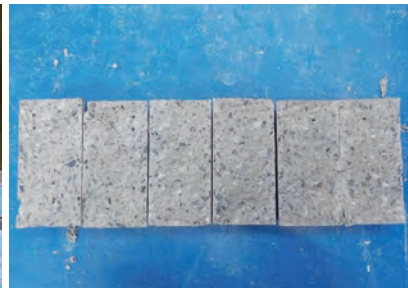
写真5 割裂引張強度試験
