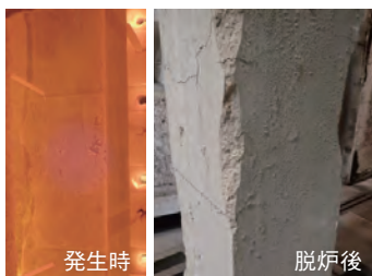
写真2 柱試験体の爆裂(軽微)
