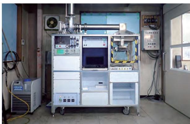
写真9 コーンカロリメータ試験装置
