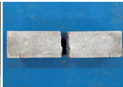
写真6 曲げ強度試験
