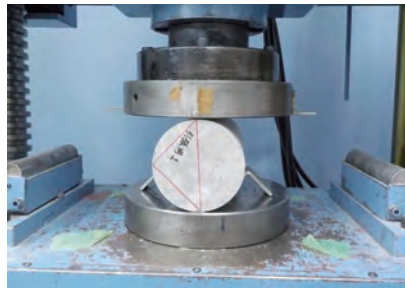
写真5 割裂引張強度試験
