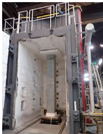
写真11 載荷加熱試験
