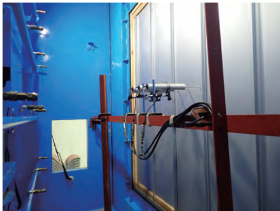
写真4 変位測定状況(試験体1)
