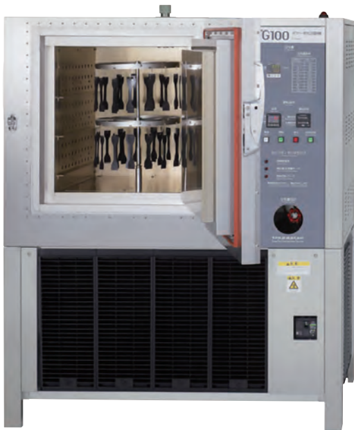
写真2 ギャー式老化試験機 1)
