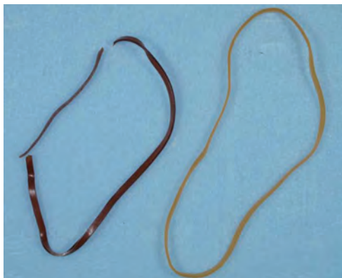
写真1 熱劣化によって硬化したゴム(左が熱劣化後)
