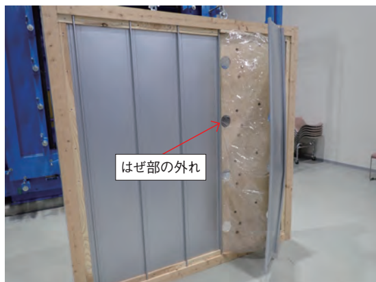
写真7 破壊状況 (試験体3)
