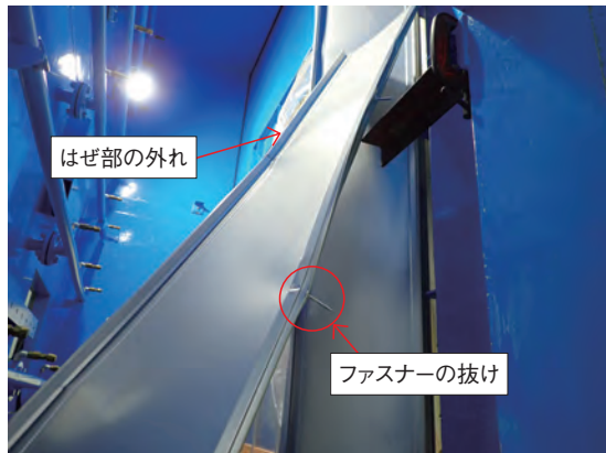
写真6 破壊状況 (試験体2)
