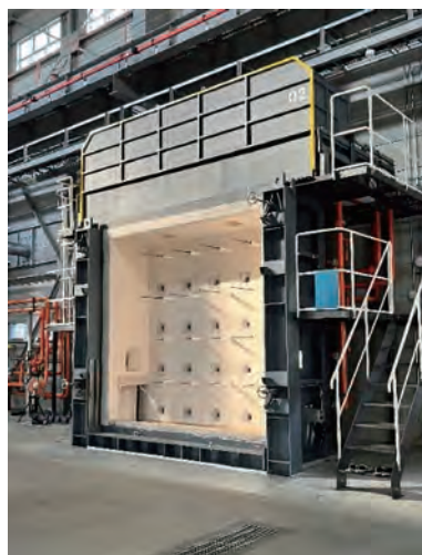
2号壁炉(载荷壁炉)
