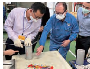
コンクリート圧縮強度試験の様子
