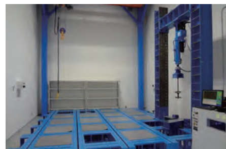
写真1 恒温恒湿室及び試験装置架台
