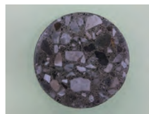
写真4 直径10cmのコンクリート供試体の切断面
