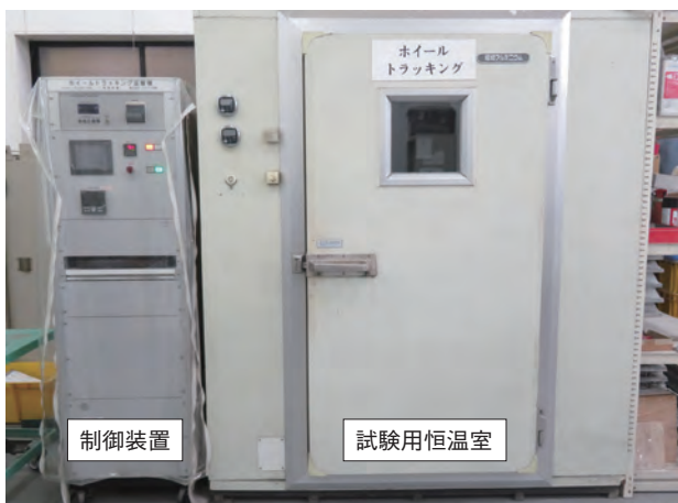
写真1 制御装置と試験用恒温室
