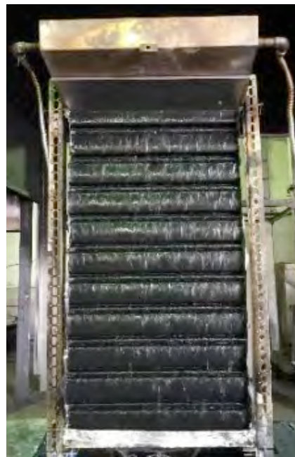
図8 鋼製シャッターを用いた水膜流実験
