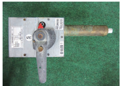
写真3 亜硫酸ガス耐食試験後の試験体 (試験体記号：亜硫酸1)
