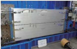
写真5 損傷状況 ・加撃点のパネルの変形
