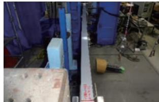
写真6 損傷状況 ・パネルの残留たわみ
