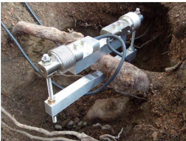
写真8 根に取り付けた肥大力測定装置
