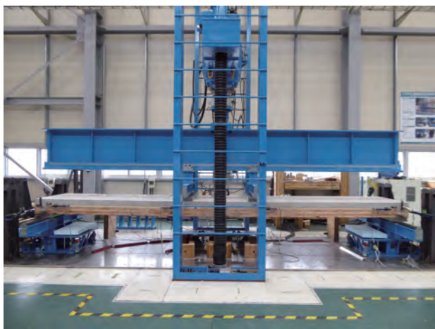
写真3 曲げ試験実施状況
