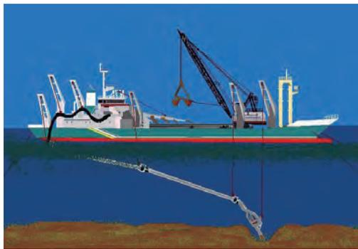
写真8 海砂の採取状況<sup>B)</sup> (骨材資源工学会 提供)
