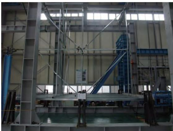
写真2 大型天井試験体(加力による終局状況)
