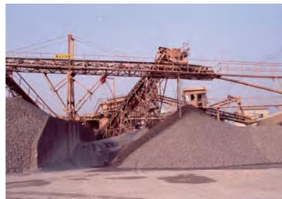
写真4 採取後の砂利・砂の篩分け
