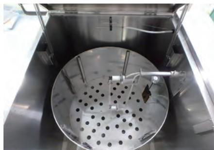
写真4 紫外線照射装置の内部
