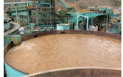
写真7 山砂の洗淨水処理槽
