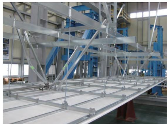
写真1 在来天井取付試験体(試験体設置状況)
