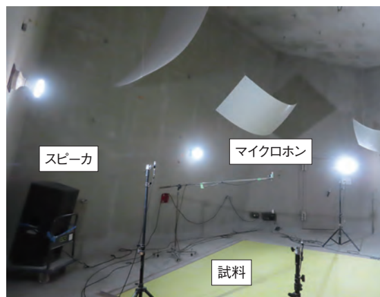
写真1 残響室法吸音率測定の様子
