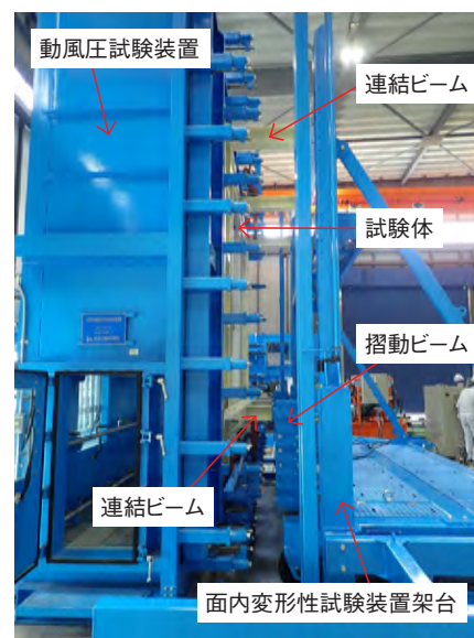
写真2 動風圧試験装置と組み合わせた状態
