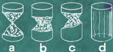
良好な破壊性状の一例
