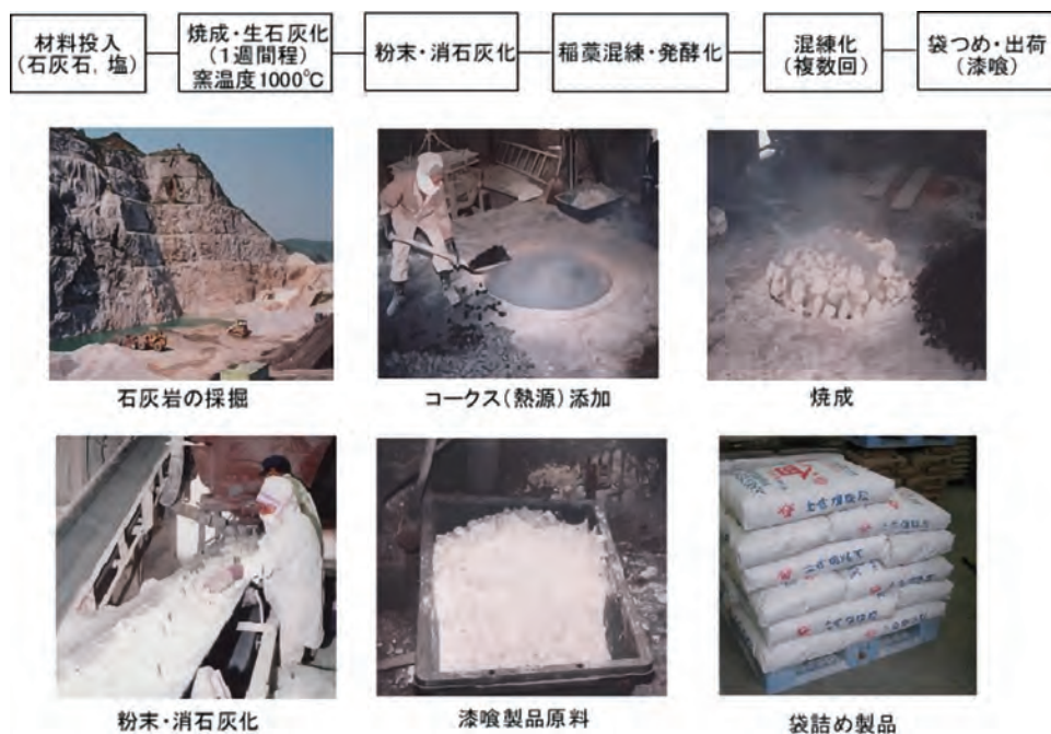
図1 伝統的な塩焼き灰の製造フロー
