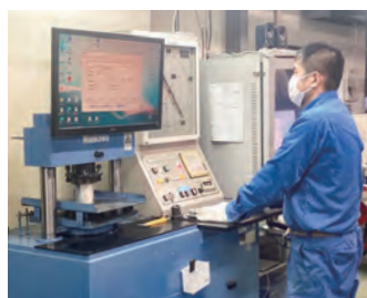
グラウトの圧縮強度試験の実演
