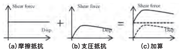
図1 突起付き鋳鉄製プレート圧着接合部の設計概念
