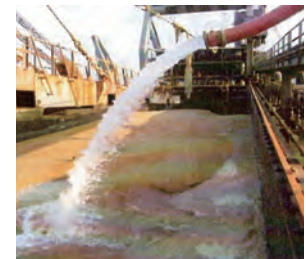
写真10 船上散水による除塩
