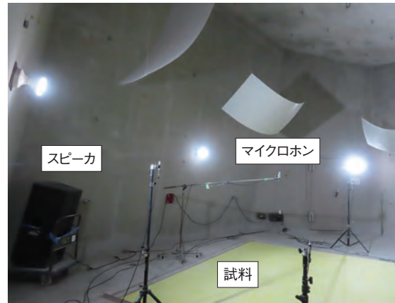
写真1 残響室法吸音率測定の様子
