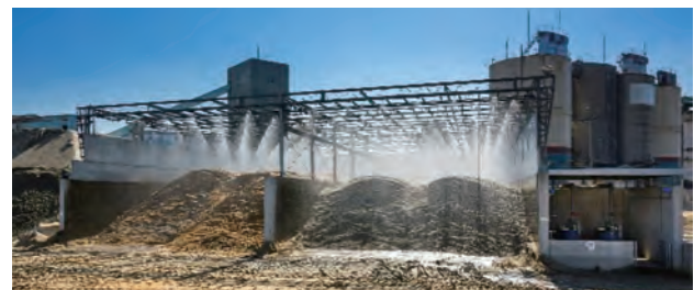
写真11 陸上散水による海砂の除塩
