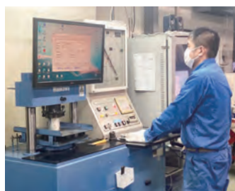
グラウトの圧縮強度試験の実演
