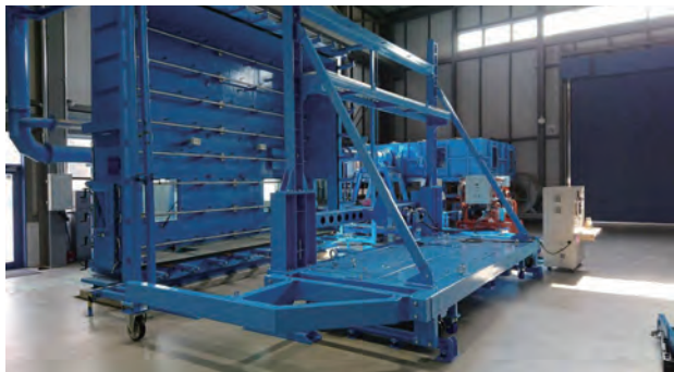
写真1 面内変形性試験装置
