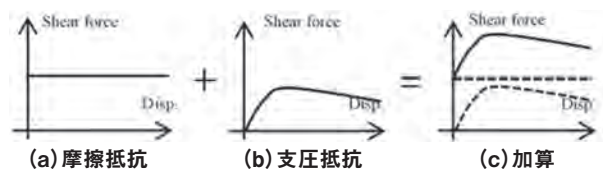
図1 突起付き鋳鉄製プレート圧着接合部の設計概念
