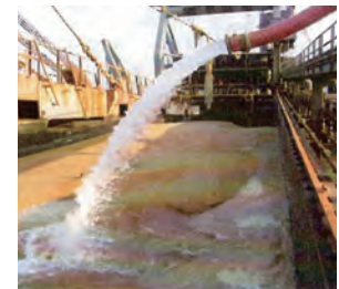
写真10 船上散水による除塩
