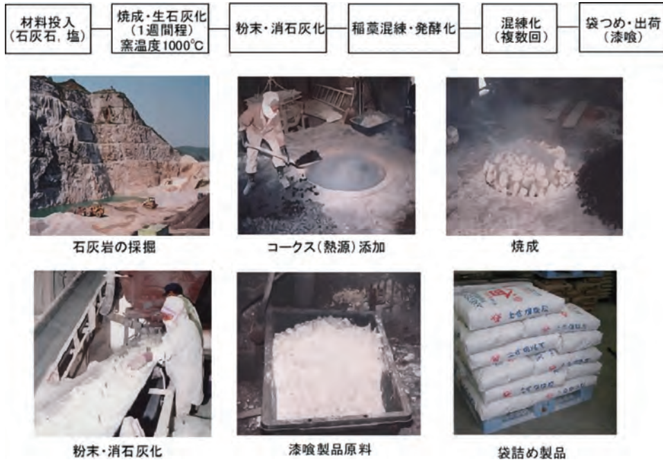
図1 伝統的な塩焼き灰の製造フロー
