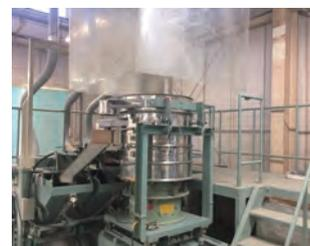
路盤材のふるい分け試験装置
