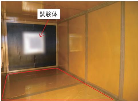
写真1 室内側の漏水状況 (写真奥に換気ガラリ設置)
