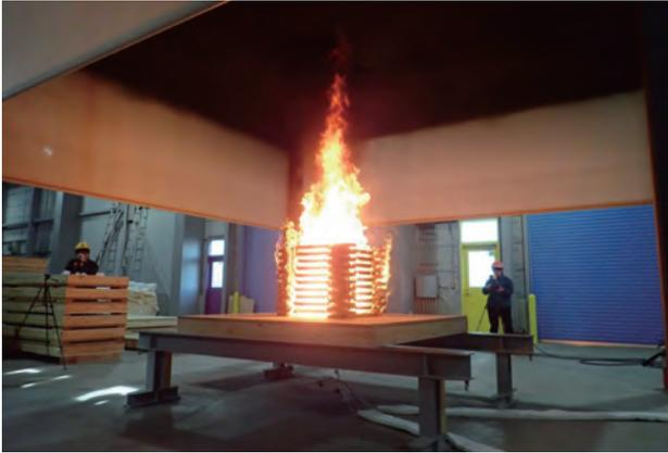
写真4 クリブを火源とした床の燃焼実験の様子
