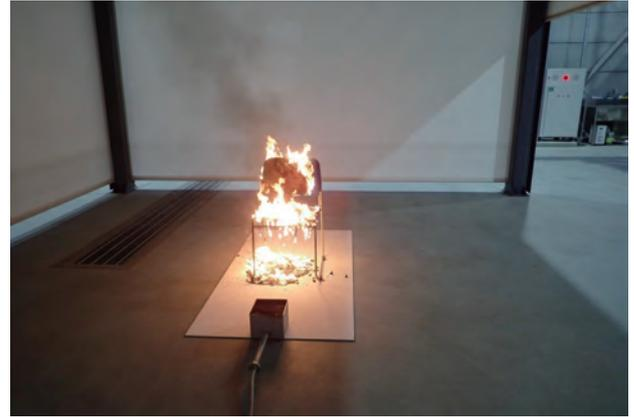
写真5 椅子の燃焼実験の様子
